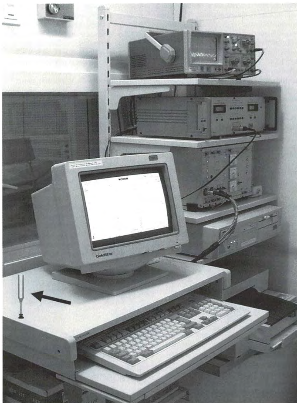
Abbildung 1: Computergesteuerte Untersuchungseinheit zur Ableitung akustisch evozierter Potentiale. Im Größenvergleich dazu eine Stimmgabel (Pfeil) für Diagnosezwecke – ein scheinbar archaisches Instrument, das auch heute noch unverzichtbare Dienste in der Hördiagnostik leistet.
