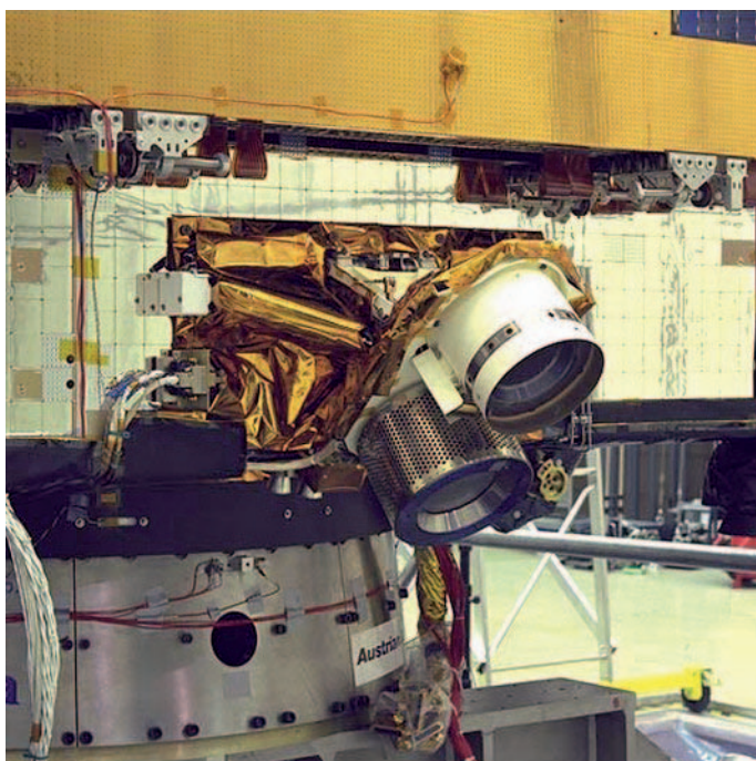
Abb. 4: Ionentriebwerk „RIT-10“ (mit weißer Hülle) neben einem britischen Kaufman-Triebwerk „UK-10“ auf der Hülle des ESA-Satelliten „Artemis“.
