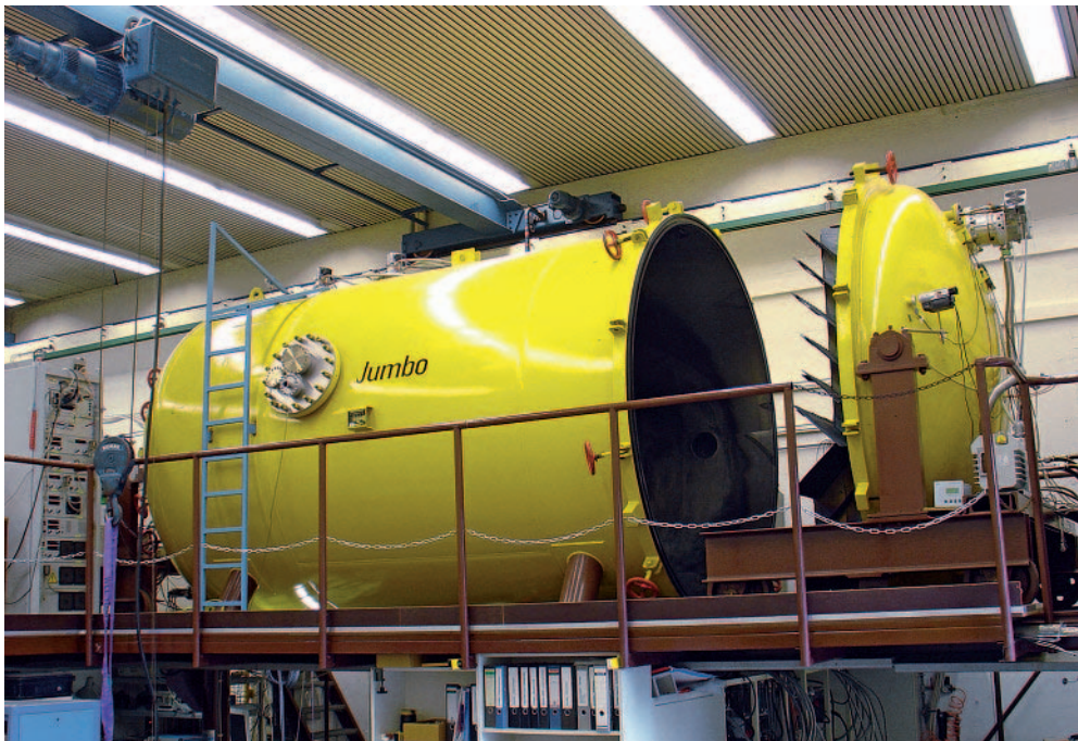
Abb. 1: Die Gießener Hochvakuum-Testanlage „Jumbo“ für Iontriebwerke; mit einem Kammervolumen von 30 m 3 und einer Pumpgeschwindigkeit von 100.000 Litern pro Sekunde ist sie der größte Prüfstand in Deutschland. Bild: JLU
