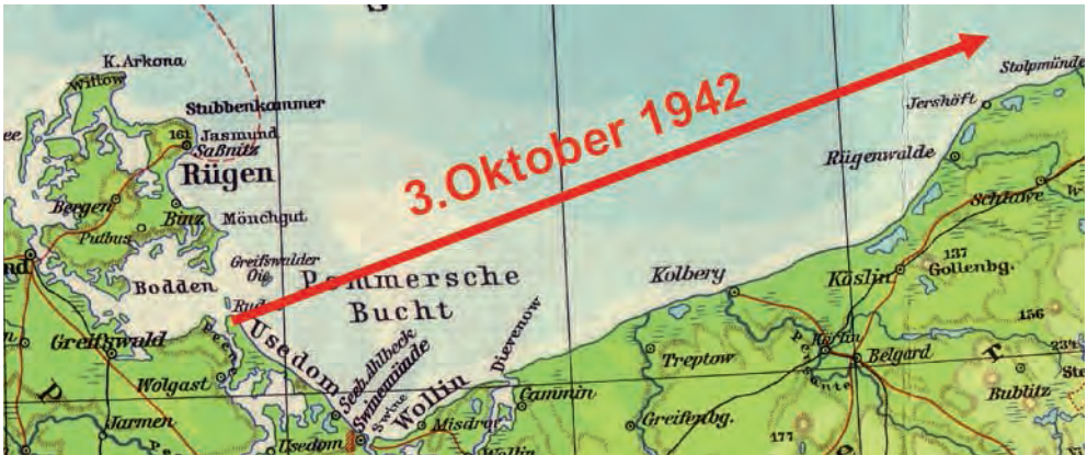
Abb. 6: Flugstrecke der vierten Testrakete der Serie A4 vom 3. Oktober 1942. Bei späteren Versuchen wurden Entfernungen von fast 300 km erreicht. Bei diesem Versuch mit 190 km Entfernung erreichte die A4 erstmals eine berechnete Höhe von 82 km und damit den Weltraum. Das Protokoll vermerkt „zu steil“.
